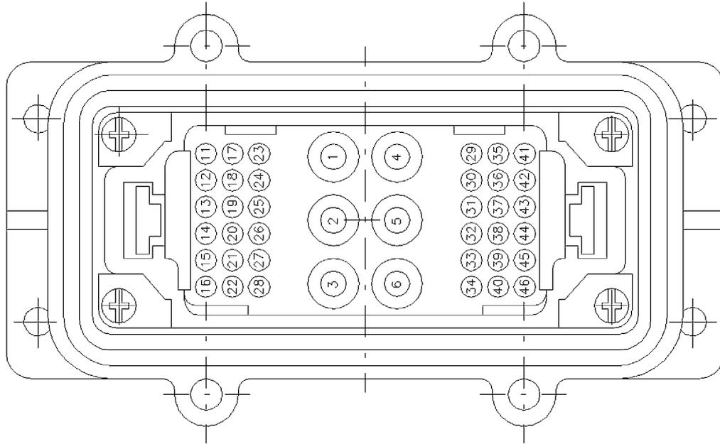
Схема внутренних цепей электроприводов **MODACT MPS, MPSP**
