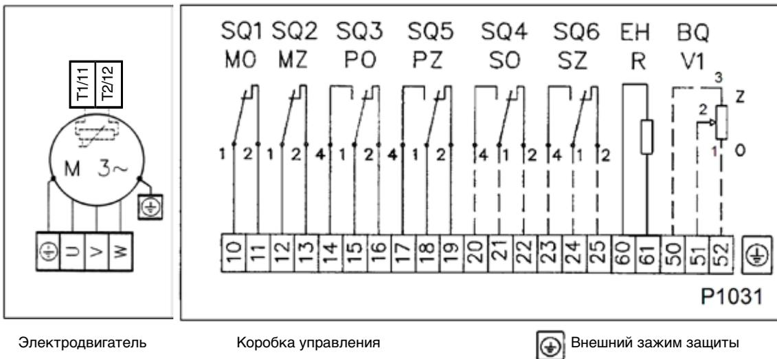
– исполнение с токовым датчиком положения CPT 1Az
