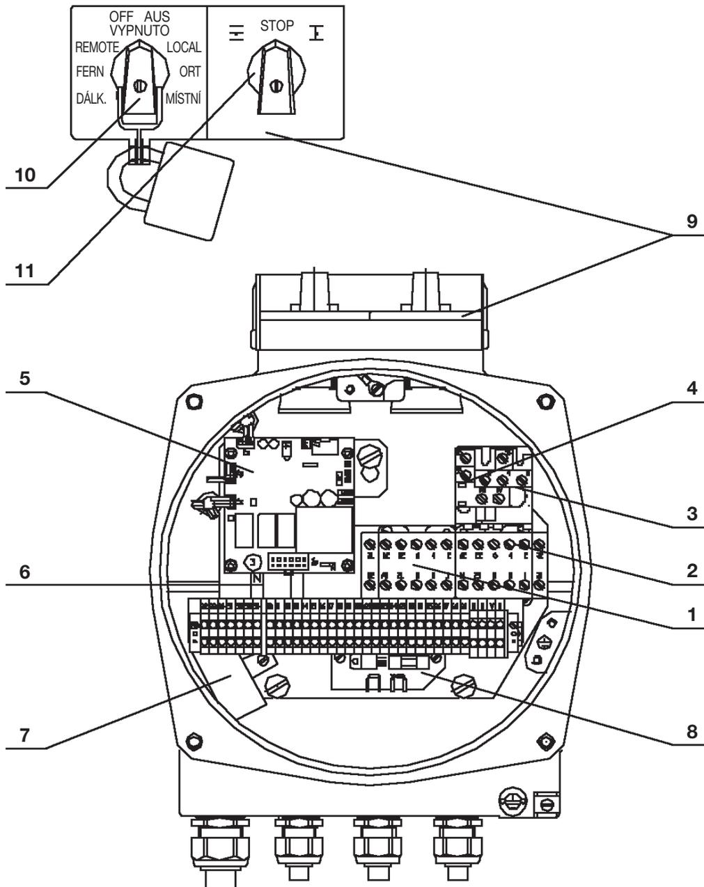
**Примечание:** Состав оснащения коробки клеммника, а также количество и обозначение зажимов клеммника отличаются в зависимости от конкретного исполнения электропривода.
