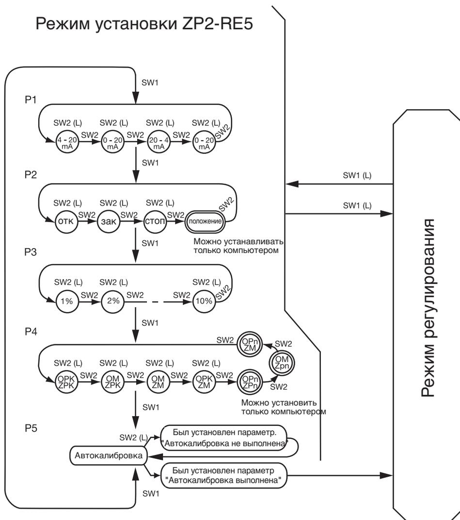
Рис. 2 – Графическое представление управления с помощью кнопок
